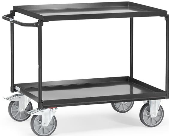
Construction en acier avec 2 plateaux étanches et rebord de 40 mm, revêtement époxy gris anthracite RAL 7016, dossier de poussée horizontal. Charge maximum plateau du haut: 200 kg. 2 roues pivotantes et 2 roues fixes à bandage TPE, moyeu à roulement à billes central. Freins sur roues pivotantes.
