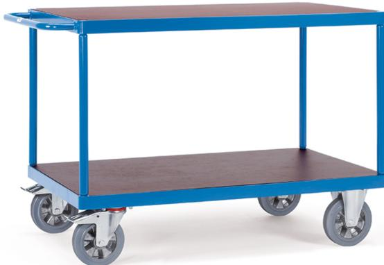
Ensemble mécano-soudé, revêtement époxy bleu RAL 5007. Plateaux en aggloméré antidérapant, plastifié et hydrofuge. Chariot spécialement conçu pour transporter des charges lourdes, les roues à bandage élastique sur jantes en aluminium avec moyeu à roulement à billes permettent un déplacement aisé et confortable. 2 roues fixes et 2 roues pivotantes à bandage caoutchouc élastique, bleu-gris non traçant. Freins sur roues pivotantes. Charge plateau du haut: 500 kg.
