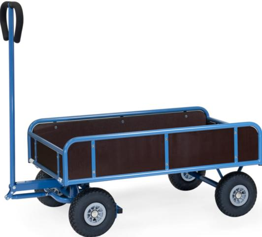
En tube d'acier soudé, revêtement époxy bleu RAL 5007. Ridelles hauteur 250 mm, Plateau et ridelles en contreplaqué hydrofuge. Essieu avec timon. Roues gonflables, moyeu à roulement à rouleaux. Poignée sécurisée avec revêtement souple remontant automatiquement en position verticale. Blocage automatique de l'essieu avant.
