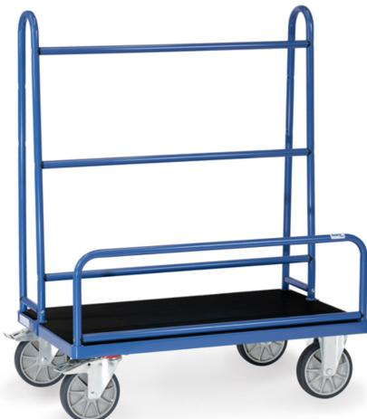
Ensemble mécano-soudé, revêtement époxy bleu RAL 5007. Plateforme en mélaminé surface avec revêtement caoutchouc. Armature en tôle d'acier à boulonner. 2 roues fixes et 2 roues pivotantes à bandage TPE, moyeu à roulement à billes. Freins sur roues pivotantes. Hauteur utile: 1 050 mm. Hauteur du tube cintré d'arrêt: 300 mm.
