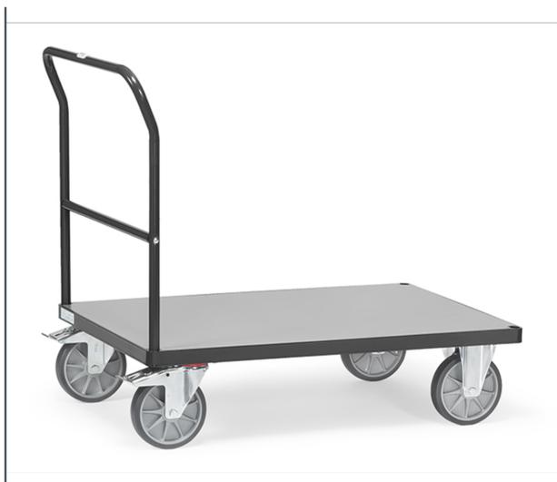
Système modulaire. Ensemble mécano-soudé, revêtement époxy gris anthracite RAL 7016, plateau en mélaminé surface gris moyen. 2 roues pivotantes et 2 roues fixes à bandage TPE, moyeu à roulement à billes central. Freins sur roues pivotantes.
