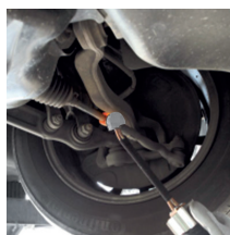
Déblocage des biellettes de direction
