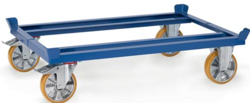
Construction en profilé d'acier mécano-soudé, revêtement époxy bleu RAL 5007, avec 4 inserts support de palettes. Pour palettes bois ou grillagées. 2 roues fixes et 2 roues pivotantes en polyuréthane jante en aluminium, moyeu à roulement à billes. Freins sur roues pivotantes. Peu de résistance au démarrage et à la rotation. Déplacement silencieux sur sols plats. Roues non traçantes.
