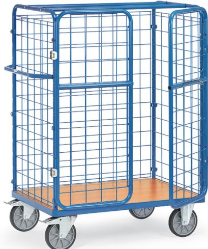
Ensemble mécano-soudé, revêtement époxy bleu RAL 5007. 1 plateau fixe en mélaminé surface effet hêtre. 3 côtés grillagés maille de 100 x 100 x 5 mm. Double porte battante, armature en tube habillée de treillis 100 x 100 x 5 mm. Verrou à douille intégré dans l'armature, portes rabattables sur les petits côtés. Hauteur 1552 mm. 2 roues pivotantes et 2 roues fixes à bandage TPE, moyeu à roulement à billes central. Freins sur roues pivotantes.
