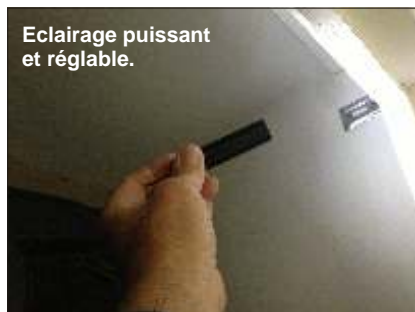
20 mm de diam  tre, 33 Gr et 86 mm de longueur : la cam  ra peut-  tre utilis  e sans perche, avec ou sans   clairage.
