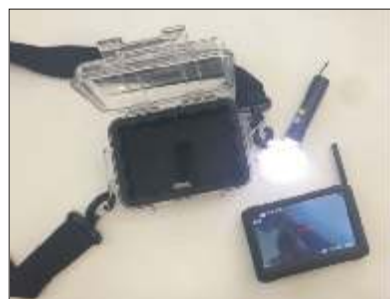
Le moniteur-r  cepteur-enregistreur peut   tre visualis   tel quel ou prot  g   dans un bo  tier   tanche et anti-choc ou sur un support de poignet (en option).
