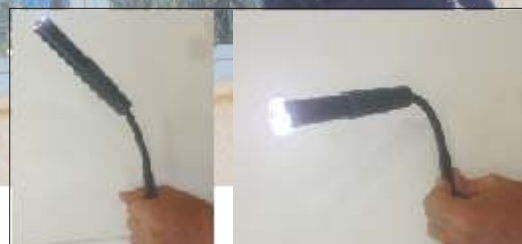
La derni  re section qui supporte la cam  ra est    m  moire de forme pour une pr  -orientation avant l'exploration.
