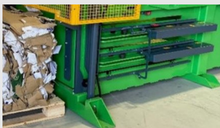
Changement rapide des fils avec attaches rapides
