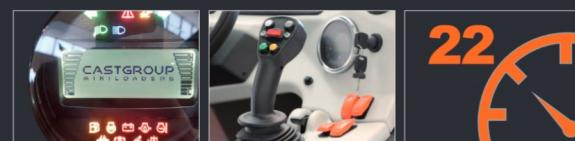
Écran électronique avec voyants qui indiquent les anomalies, le moteur, la jauge d'huile hydraulique et le système de flottement électrique.
