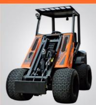
La série 30 est compacte. Avec 2445mm de longueur, 1160mm de min. largeur et 1970mm de min. hauteur, elle est capable d'entrer dans les endroits les plus étroits et est facilement transportable.
