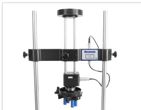
Traverse et colonne mobile sur laquelle repose le capteur
