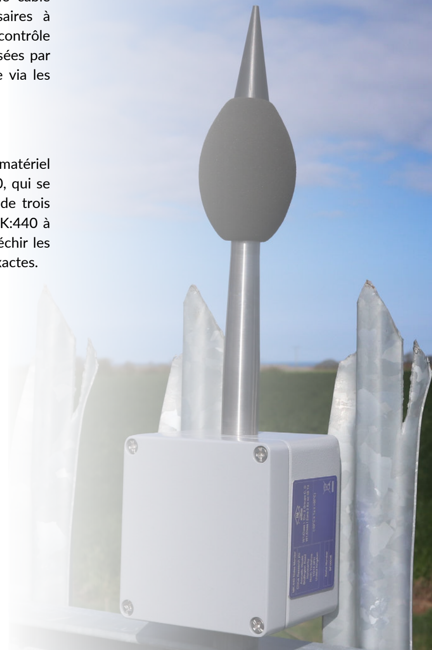
Les clips Jubilee permettent de fixer le MK:440 à un poteau ou à un mât.
