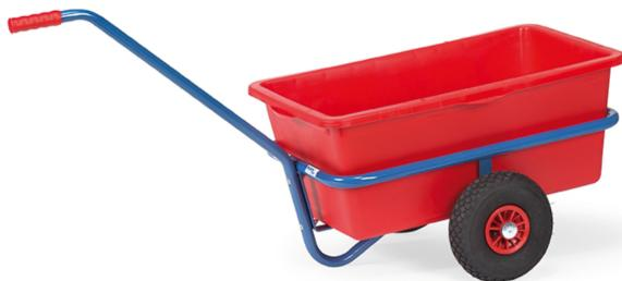
Char à bras léger en tube et profilé d'acier soudés, revêtement époxy bleu RAL 5007. Timon à boulonner. Avec cuvette rouge contenance 90 litres. Roues gonflables, moyeu à roulement à rouleaux. Livré non monté, montage facile.
