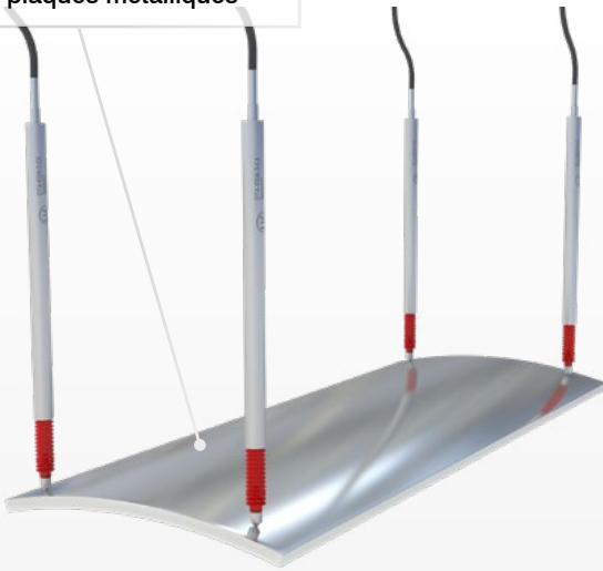
Inspection du fléchissement des plaques métalliques
