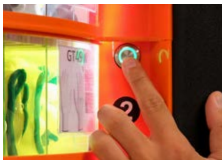
Bouton lumineux pour signaler et sélectionner le produit à prélever.
