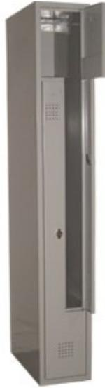
Armoires monoblocs réalisées en tôle d'acier électro-zinguée cuite au four à 195°. Epaisseur de tôle 8/10 et 10/10 de mm. Tôle laminée à froid, dégraissage de la tôle, phosphatage et passivation, polymérisation, soudure par points semi-automatique par du fil de 30% d'argent.
