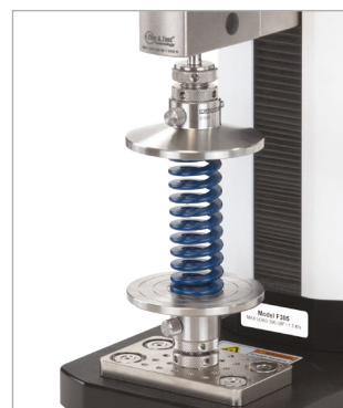
Test de compression de ressort
