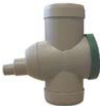
Collecteur classique (ref:1401000461) Pour des surfaces de toiture jusqu'à 60 m². Modèle en PP, avec maillage inox et tubulure de sortie adaptable aux descentes de gouttière en Ø 32 mm et Ø 50 mm.
