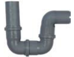
Trop Plein DN 50 ref: 1401000168 Tuyau en PP de Ø 50 mm. Joint DN 50 inclus. Convient lorsqu'un tuyau de remplissage de 1" maximum est utilisé.
