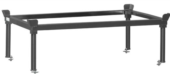
Construction mécano-soudée en profilé d'acier avec 4 supports, revêtement époxy RAL 7016. Barres de soutien avec pattes de renfort. Les supports amovibles pour rouleurs de palettes permettent de placer les charges à hauteur idéale et peuvent être fixés au rouleur au moyen d'un système de vissage sur pattes très solide.
