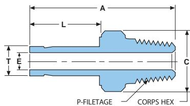
Ce type d'adaptateur permet de convertir une extrémité NPT femelle en une extrémité tube avec empreinte de bagues usinées, pour le montage d'un raccord à embout GYROLOK®.
