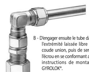
Vous souhaitez, par exemple, raccorder un tube ayant une orientation fixe sur l'embout NPT femelle d'un raccord ou d'un autre tube formant avec lui un angle droit.
