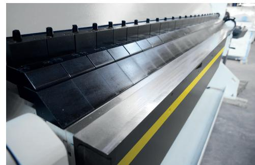
Pliuse hydraulique très stable avec un bâti en acier mécano soudé. Ajustement facile des tabliers supérieur et inférieur grâce au volant. Ajustement de l'angle de pliage via une échelle de mesure jusqu'à 135°. Commande de la machine via un joystick ou une pédale au pied.
