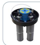
L'option SP est le système le meilleur pour le décolmatage automatique du filtre, qui utilise l'air comprimé à 6 bars pour nettoyer les cartouches. Grâce à sa grande surface et à sa efficience, il est possible de travailler aussi avec des quantités importantes de poussières fines. Les filtres sont aluminisés et antistatiques, avec une filtration en classe M-BIA (EN 60335-2-69). Le décolmatage fonctionne pendant que l'aspirateur est en marche.
