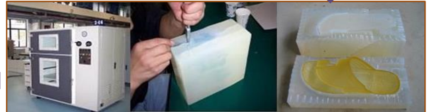
4-Après dégazage et étuvage il faut découper le moule selon le plan de joint.
