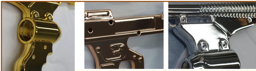
Usinage en ABS avec la finition poli-glace + chromage en couleur doré/ or rose/platine
