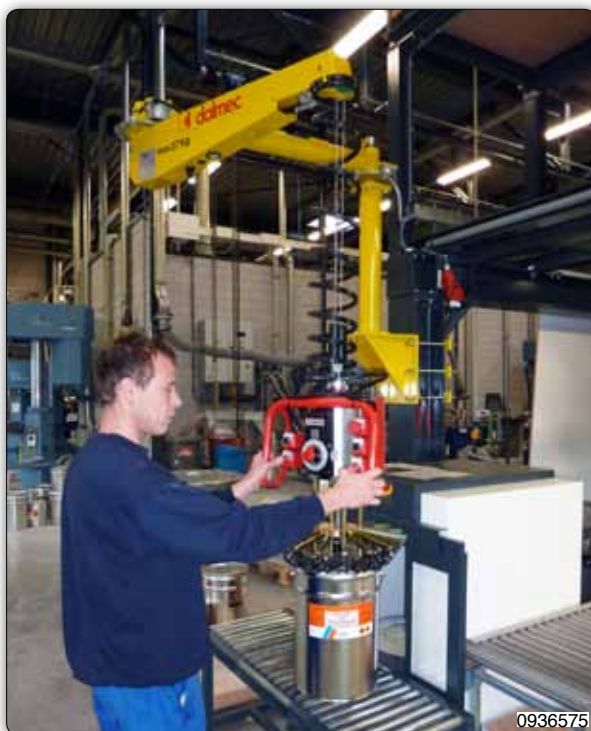
Manipulateur équipé d'un outil permettant à la fois le sertissage du couvercle et la manipulation du seau.
