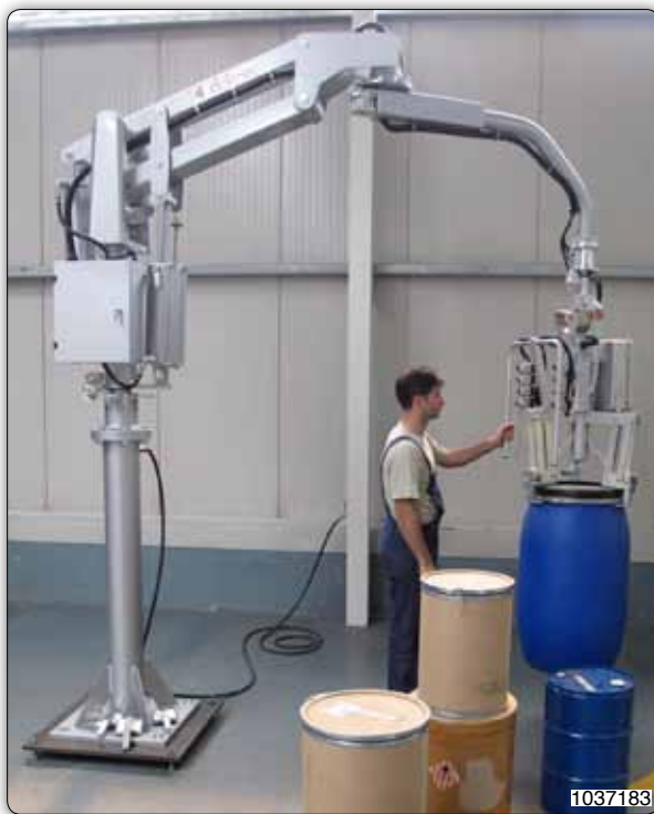
Manipulateur type PMC sur colonne pour saisir et déplacer des fûts de géométries et de masses différentes. Les mors de préhension sont facilement et rapidement interchangeables.
