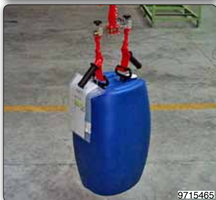
Manipulateur équipé d'un crochet spécifique pour la prise et la manipulation de seaux.
