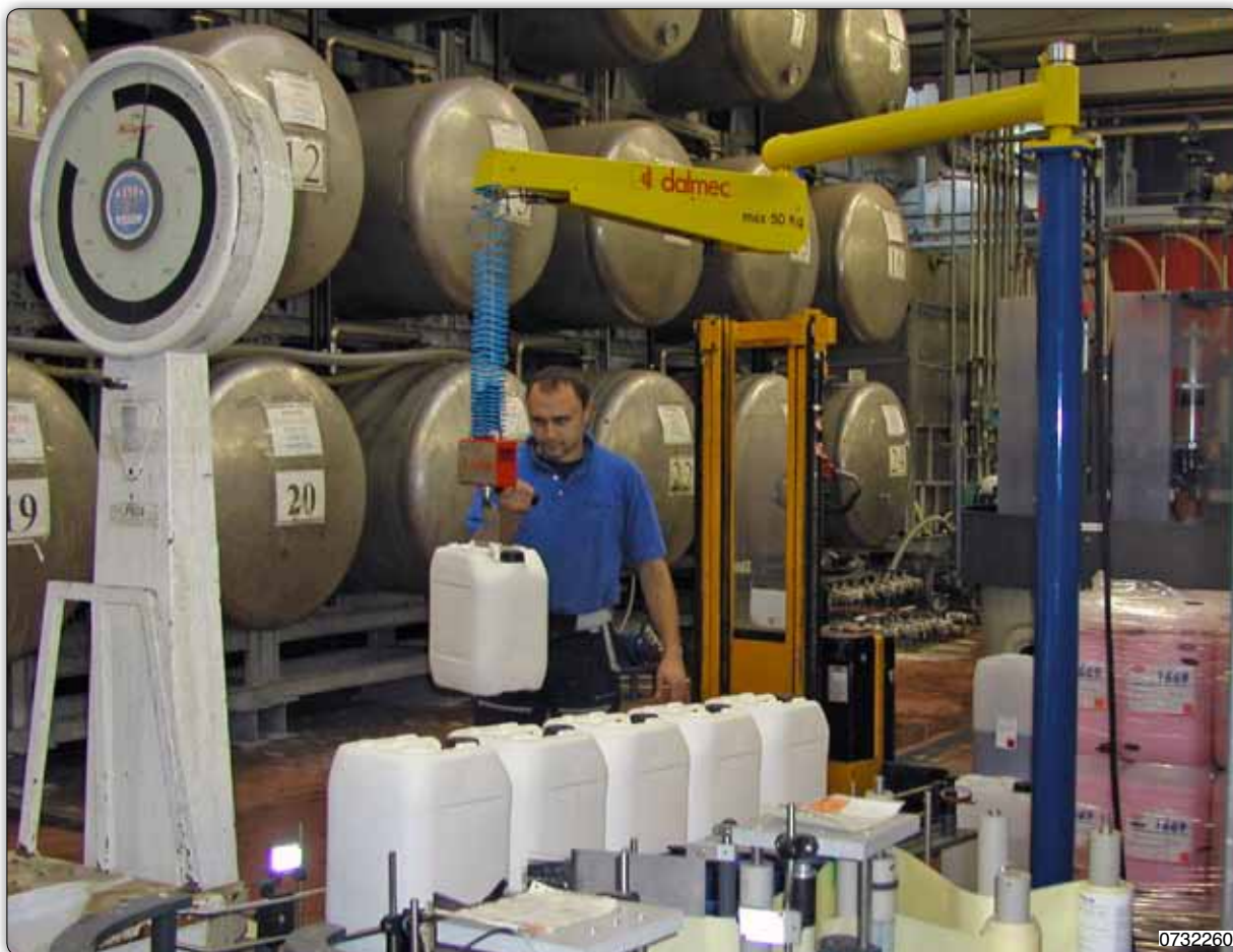
Manipulateur type PVC sur colonne équipé d'un crochet spécifique pour la palettisation de jerrycans.
