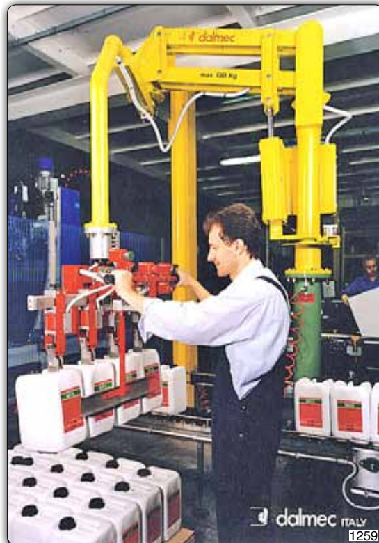
Manipulateur type PMC sur colonne équipé d'un outil à pince pneumatique pour la manipulation simultanée de bidons.
