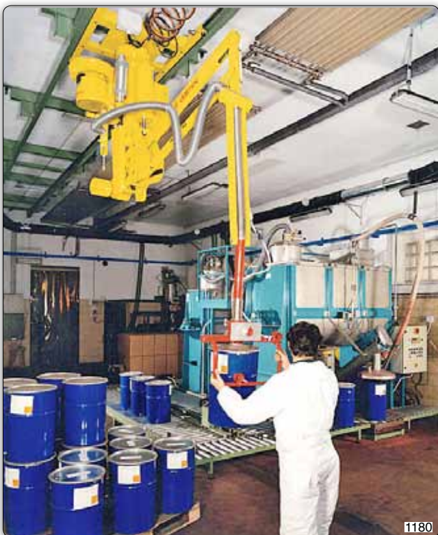
Manipulateur type PSS aérien mobile avec outil de préhension à ventouses. Le vide est généré par un éjecteur "Venturi".
