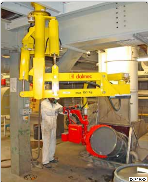
Manipulateur type PMF aérien fixe réalisé pour la prise et le déversement de fûts.
