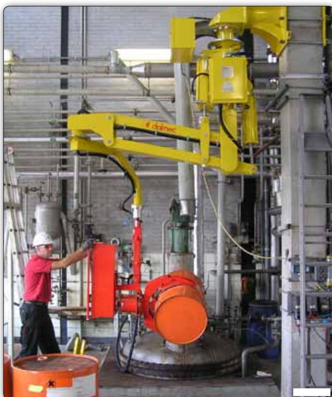
Manipulateur type PMF aérien fixe. Il permet la prise, le transfert et la vidange de fûts.
