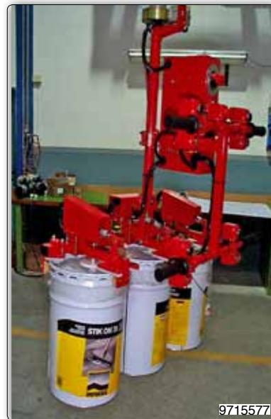
Outil de préhension à pince pneumatique pour la manipulation simultanée de trois bidons.
