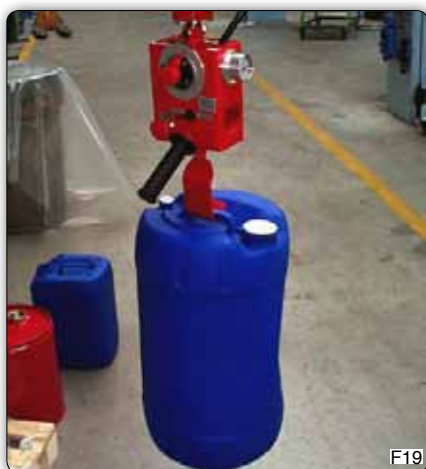
Manipulateur type PVC sur colonne équipé d'un crochet spécifique pour la palettisation de jerrycans.
