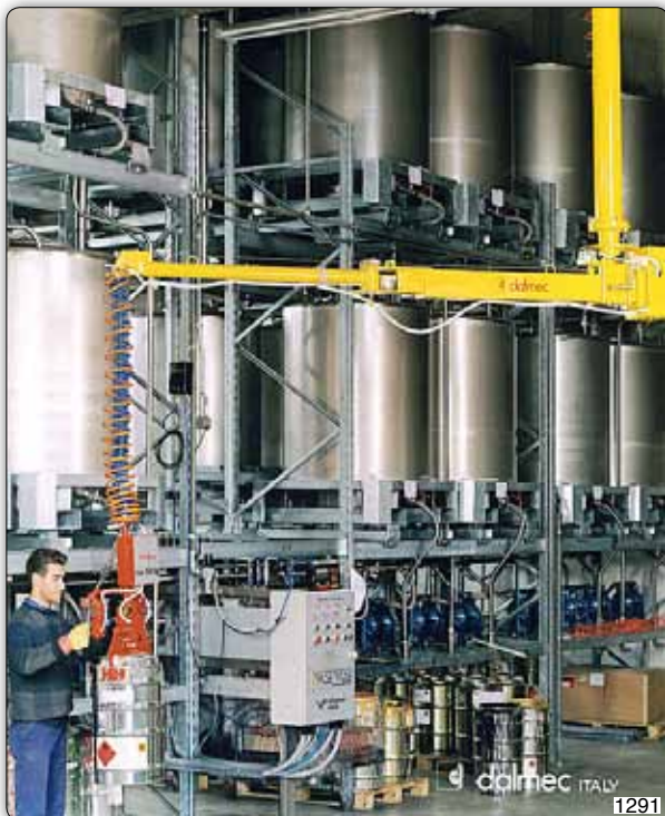
Manipulateur type PFF aérien fixe pour la manipulation de conteneurs métalliques.
