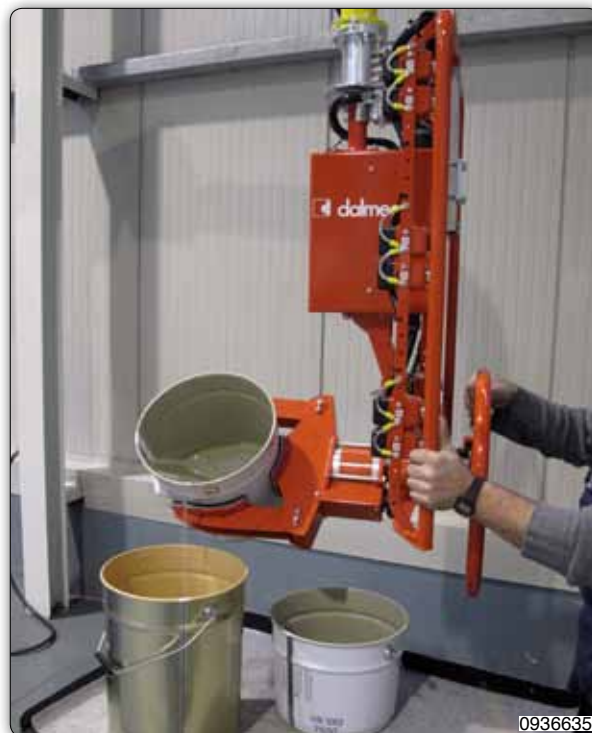
Manipulateur type PMC sur colonne adapté pour la prise et le déversement de seaux.
