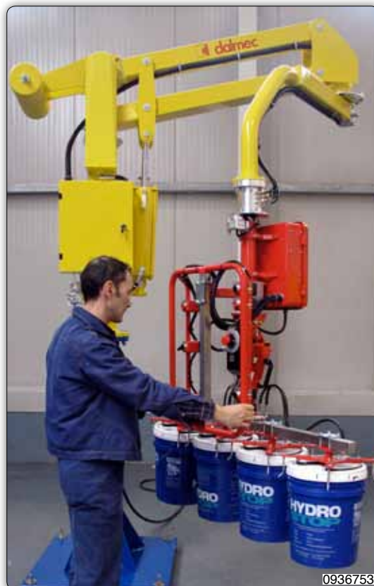
Manipulateur type PMC sur colonne équipé d'un dispositif de préhension pour la palettisation d'un ou plusieurs seaux à la fois.
