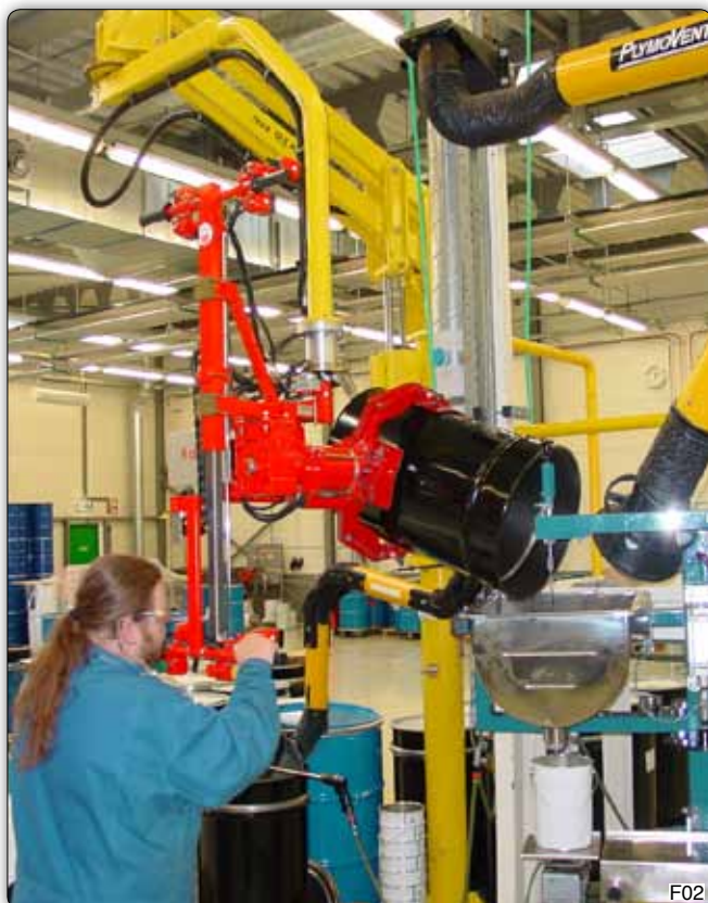
Manipulateur type PMC sur colonne réalisé pour la prise et le déversement de fûts.
