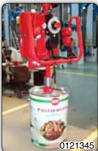
Quelques exemples de dispositifs pour la prise et la manutention de fûts et seaux.
