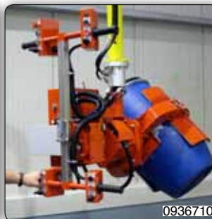
Quelques exemples de dispositifs pour la prise et la manutention de fûts et seaux.
