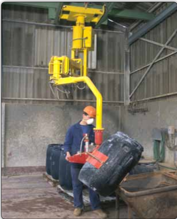
Manipulateur type PMS aérien mobile adapté pour desservir plusieurs postes de travail. Il est ici équipé d'un outil à pince pneumatique pour le déversement de fûts.
