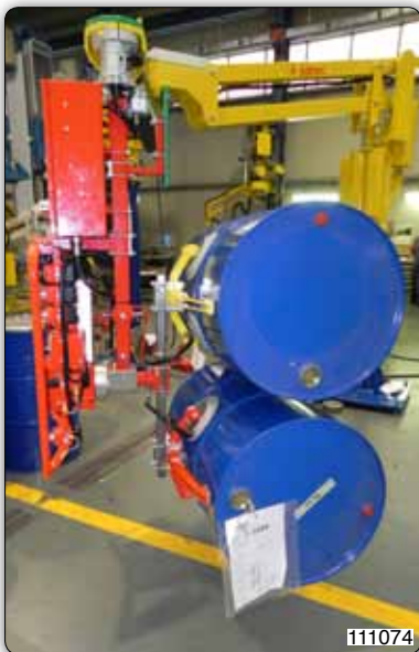
Manipulateur avec outil de préhension à ventouses pour la manipulation de fûts.
