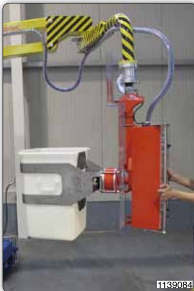
Manipulateur équipé d'un outil à pince pneumatique pour la manutention de bidons.
