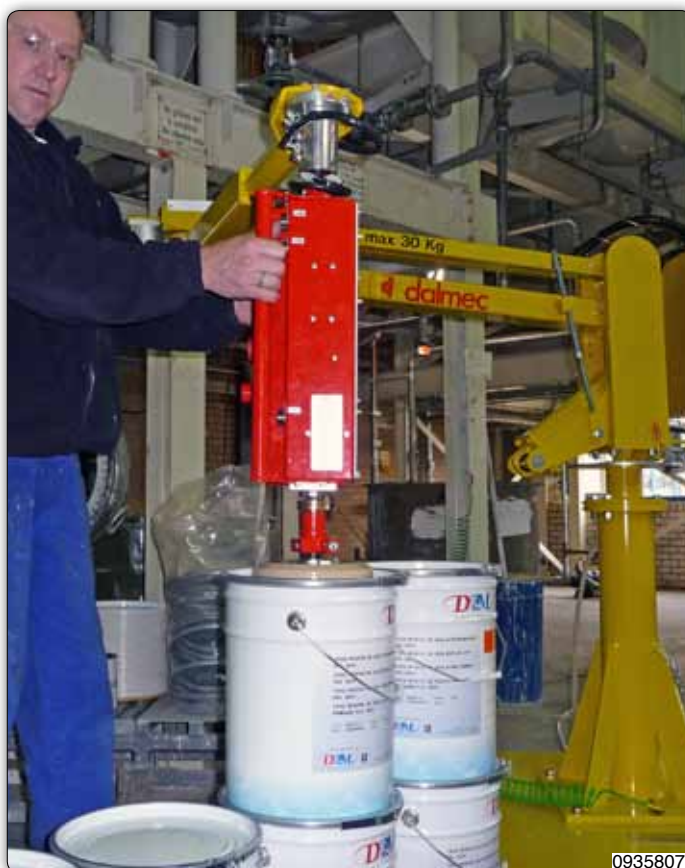
Manipulateur avec outil à ventouse (éjecteur Venturi) pour la prise et la manipulation de seaux sur le couvercle.
