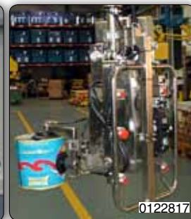
Outil de préhension à pince pneumatique pour la manipulation simultanée de trois bidons.
