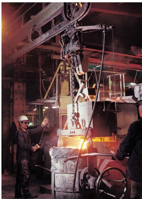
Coulée de four de fusion
