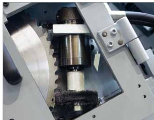
\_ Lubrification automatique de toutes les parties mobiles pour garantir leur bon fonctionnement. La lubrification peut être temporisée au moyen du contrôle de la machine. Le système est composé d'une pompe et de trois buses de nébulisation.
