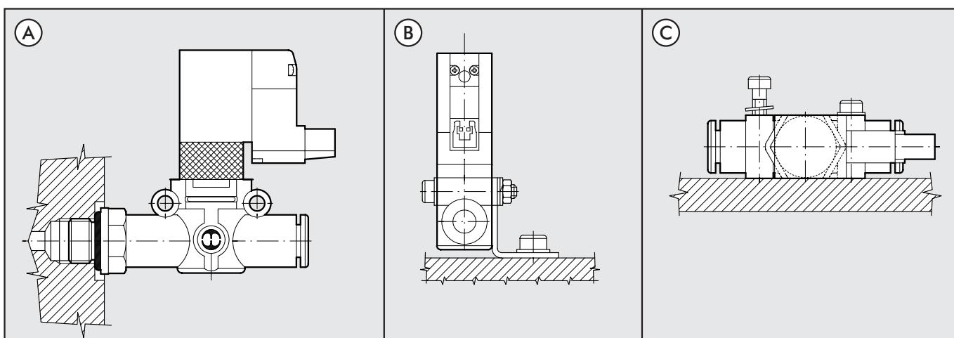
Les électrovannes en ligne série SOV L peuvent être montées de trois façons différentes:
