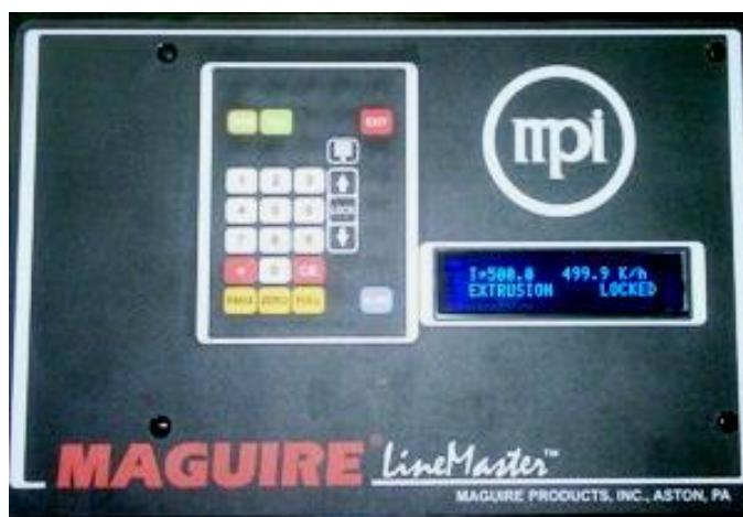
Une fois que le débit voulu est atteint, le mode VERROUILLAGE est activé et le système Maguire contrôle et maintient l'objectif fixé sur le contrôleur LIW.
