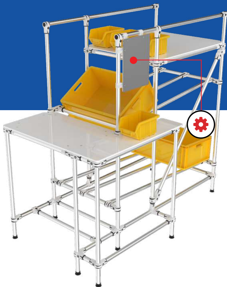
Poste de travail modifié avec flux FIFO et porte-document
