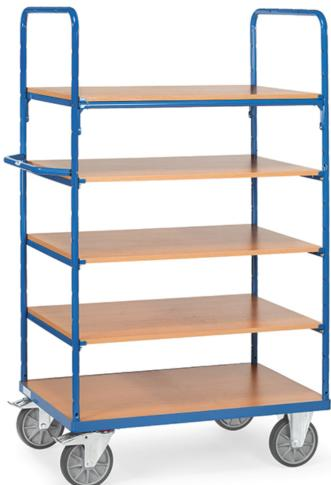
Ensemble mécano-soudé, revêtement époxy bleu RAL 5007. 1 plateau fixe et 4 amovibles en mélaminé surface effet hêtre. Plateaux amovibles réglables au pas de 100 mm. Charge maximum par plateau: 90 kg. 2 roues pivotantes et 2 roues fixes à bandage TPE, moyeu à roulement à billes central. Freins sur roues pivotantes.
