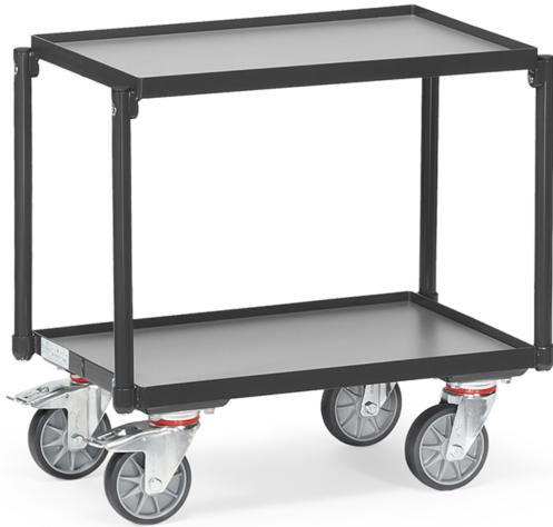
Construction en profilé d'acier, revêtement époxy gris anthracite RAL 7016. 2 plateaux en mélaminé surface gris moyen avec rebord de 15 mm, distance entre les plateaux: 400 mm. Hauteur totale: 630 mm. 4 roues pivotantes à bandage TPE, moyeu à roulement à billes central. 2 roues avec freins. Compatibles pour bacs plastiques 600 x 400 mm.
