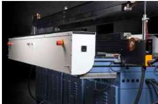
La plieuse élite Digital peut adapter son espace de travail en utilisant deux barres de chauffe à l'avant et deux barres de chauffe à l'arrière en y ajoutant une table optionnelle.
