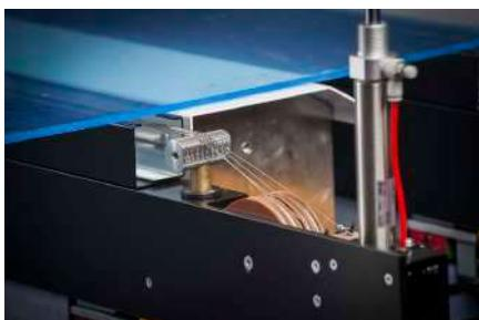
Chaque barre peut accueillir jusqu'à quatre fils, soit 4 fils dessous et quatre fils au-dessus du matériau à chauffer.
