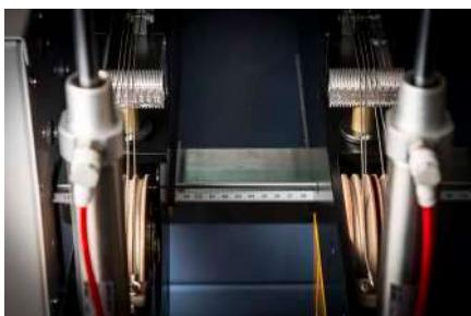
Les supports de travail maintiennent le matériau au-dessus des fils chauffants, ils sont réglables à l'intérieur et à l'extérieur pour assurer un contrôle supplémentaire des caractéristiques de chauffage.
