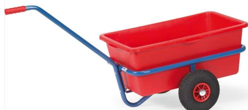
Char à bras léger en tube et profilé d'acier soudés, revêtement époxy bleu RAL 5007. Timon à boulonner. Avec cuvette rouge contenance 90 litres. Roues en mousse polyuréthane increvables, moyeu à roulement à rouleaux. Livré non monté, montage facile.
