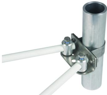
Pour tube support DEHNiso-Combi (Ø50 mm) avec 2 boulons de serrage pour tige d'écartement (Ø16 mm).
