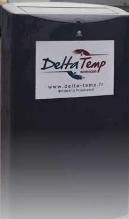
Le climatiseur monobloc local au R 410A – classe énergétique A - est une solution rapide et économique. C'est souvent la seule solution dans les bureaux où l'installation d'une unité extérieure n'est pas possible. Sur roulettes, il peut être déplacé en fonction des besoins. L'air chaud est rejeté vers l'extérieur au moyen d'une gaine.
