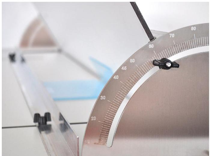
Le **IC-CC 1300 mm** permet la mise en refroidissement à l'angle souhaité, des pièces chauffées par les bancs de pliage à chaud, conçue pour n'avoir aucun contact avec la zone chauffée.
