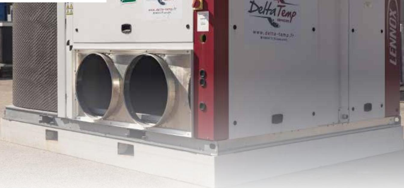
Le RFT50 est un ensemble monobloc de conditionnement d'air fonctionnant au R410A avec compresseurs multiscroll garantissant un rendement élevé à pleine charge, mais aussi à charge partielle, avec un niveau sonore réduit. Autonome et polyvalent - Pompe à chaleur et climatiseur - utilisable aussi bien l'été que l'hiver, il peut être installé en toiture ou tout autre endroit à l'extérieur.
