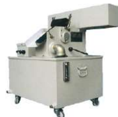
Bac d'arrosage avec pompe + séparateur magnétique
