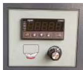
Variateur électronique de la vitesse de rotation de la meule
