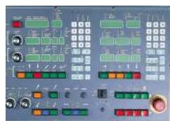
Prise de passe automatique sur le vertical avec dressage de meule automatique
