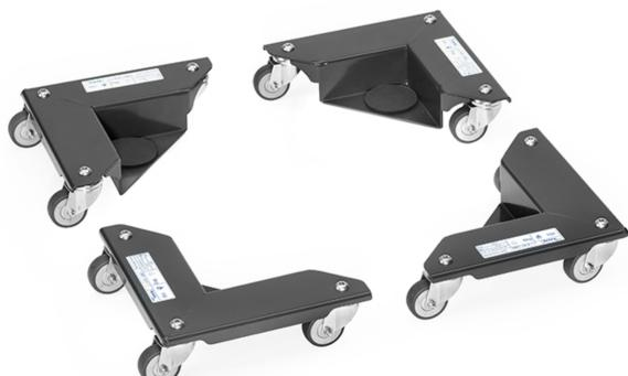
Armature en tôle d'acier soudée, revêtement gris anthracite et support antidérapant. 3 roues pivotantes TPE Ø 50 x 18 mm. Largeur: 361 mm. Profondeur: 177 mm. Hauteur: 78 mm. Hauteur au sol: 16 mm. Livraison: 1 set = 4 coins roulants (dans boîte de transport en plastique)
