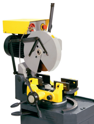
FIG. : Tête pivotante à 90°
