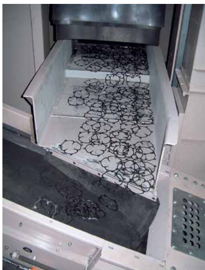
Ressorts à la sortie du couloir vibrant en aval
