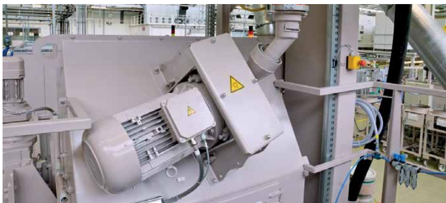
Turbine haute performance AGTOS avec régulation de l'abrasif
