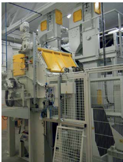
Grenailleuse à tambour AGTOS avec dispositif de chargement et barrière de sécurité
