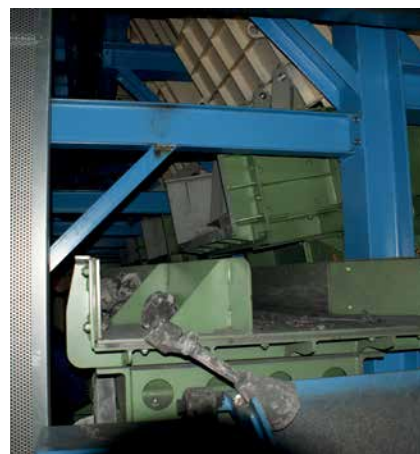
Alimentation de pièces en fonte dans la grenailleuse à tambour AGTOS
