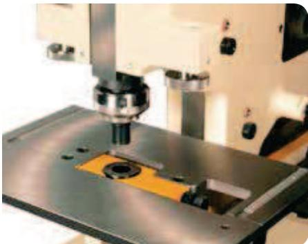
4 Porte-matrice en col de cygne pour poinçonnage de profilés L et I sur aile et âme.
