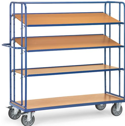
Ensemble mécano-soudé, revêtement époxy bleu RAL 5007. 1 plateau fixe et 3 plateaux amovibles en mélaminé surface effet hêtre. Plateaux amovibles avec rebord de 15 mm sur les grands côtés, réglables au pas de 120 mm. Angle d'inclinaison 15° ou 30°. 2 roues pivotantes et 2 roues fixes à bandage TPE, moyeu à roulement à billes central. Freins sur roues pivotantes.
