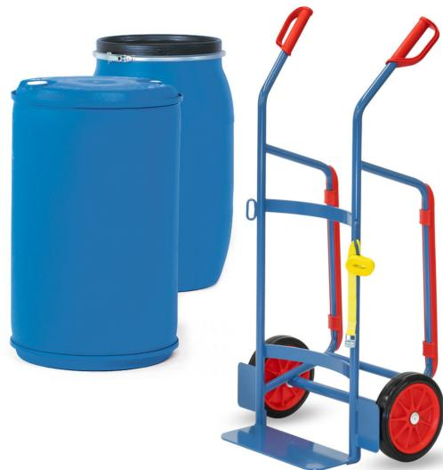
Ensemble mécano-soudé, revêtement époxy bleu RAL 5007. Diable compatible pour fûts en plastique de 120-220 litres. Sangle sécurisant la charge. Roues à bandage caoutchouc, moyeu à roulement à rouleaux. Hauteur: 1300 mm; Largeur: 640 mm.
