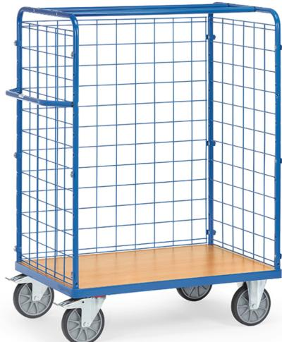
Ensemble mécano-soudé, revêtement époxy bleu RAL 5007. 1 plateau fixe en mélaminé surface effet hêtre. 3 côtés grillagés maille de 100 x 100 x 5 mm. 2 roues pivotantes et 2 roues fixes à bandage TPE, moyeu à roulement à billes central. Freins sur roues pivotantes.
