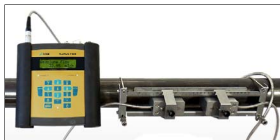
Mesure avec transmetteur de débit fixé par le kit de fixation sur la conduite
