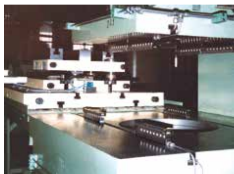
Tasseaux de serrage en double T sur la table de presse et le coulisseau
