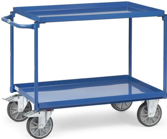
Construction en acier avec 2 plateaux étanches et rebord de 40 mm, revêtement époxy bleu RAL 5007, dossier de poussée horizontal. Charge maximum plateau du haut: 200 kg. 2 roues pivotantes et 2 roues fixes à bandage TPE, moyeu à roulement à billes central. Freins sur roues pivotantes.
