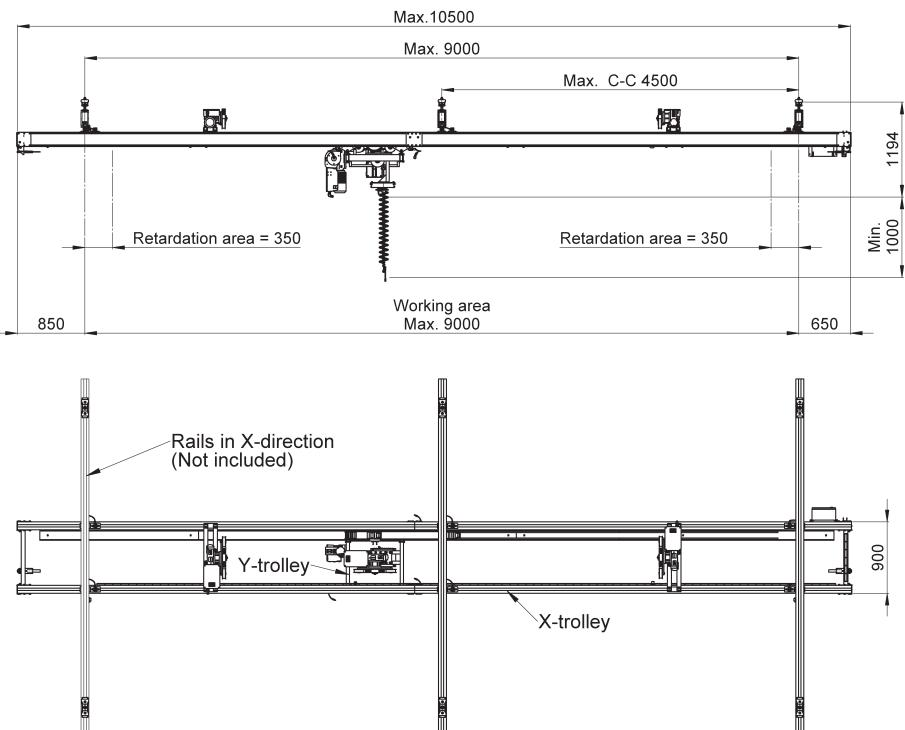
Ce dispositif de levage est livré pré assemblé, il comporte un moteur de levage et trois moteurs pour les mouvements X et Y.
