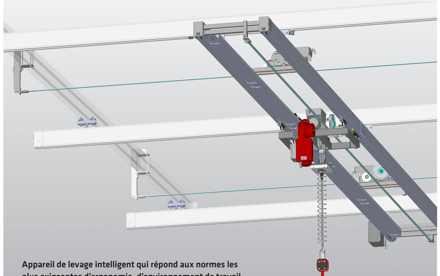
**Appareil de levage intelligent qui répond aux normes les plus exigeantes d'ergonomie, d'environnement de travail, de sécurité et d'efficacité.**
